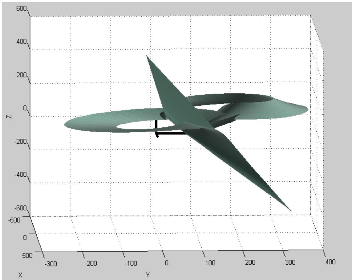
Figure 6. SPATIAL 4C DOUBLE-ROCKER COUPLER SURFACE
