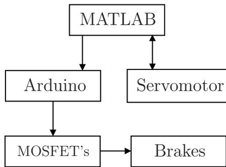
**FIGURE 15.** RMG: CONTROL SCHEMATIC
